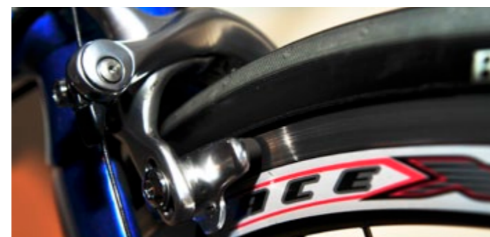
Se til at bremseklossene holder.
